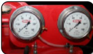
Manómetros para indicar la presión de succión.
