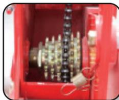
Sistema de transmisión de multivelocidad con 30 diferentes espacios entre fila y fila.
