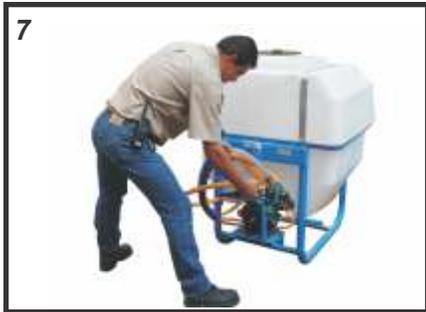
7.- Retire con precaución las mangueras de alimentación y colóquelas de la siguiente manera:
