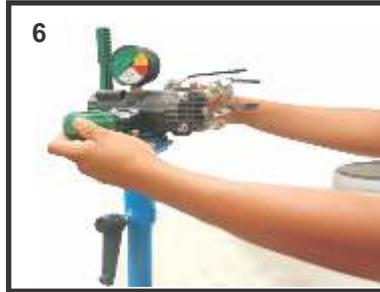
6.- Coloque el regulador con el manómetro hacia el tractor y apriete con la manija.
