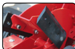
Cuenta con navajas reforzadas de alto calibre y doble vida ideal para materia verde y martillo para materia seca.
