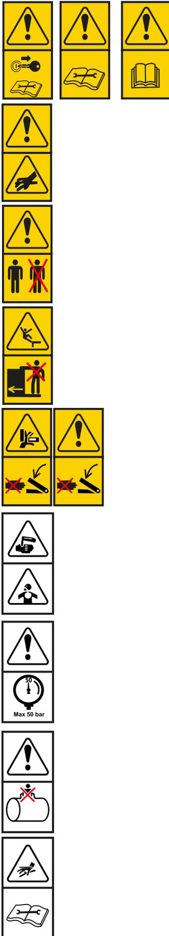
1. **PRECAUCIÓN:** operaciones de ajuste y mantenimiento deben ser llevadas a cabo después de leer el manual del usuario, con la máquina detenida y retirada la llave.
