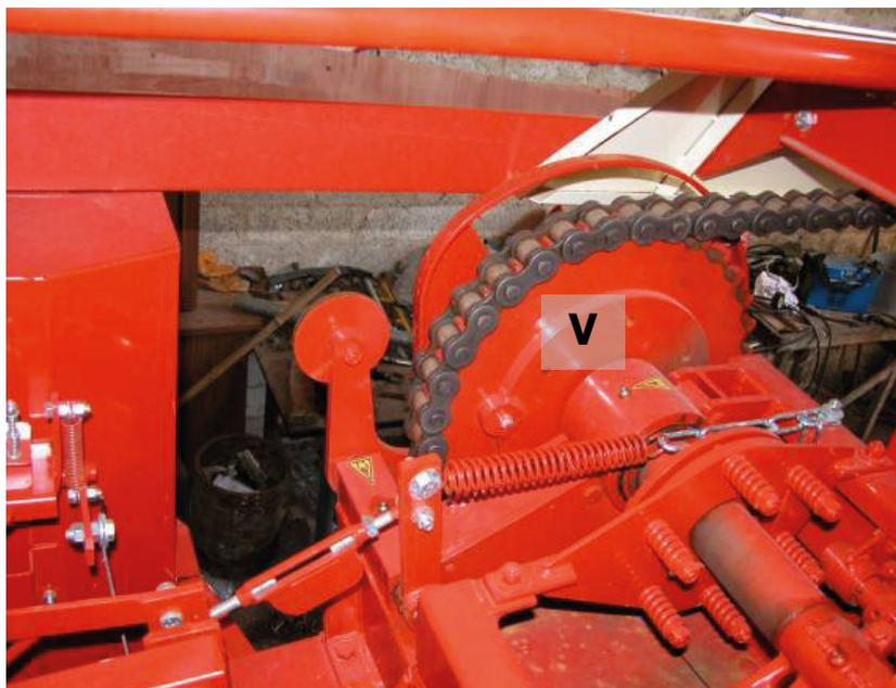
Cuando se rompe el perno de seguridad del anudador, el bloqueador del pistón entra en acción para evitar que el pistón entre en contacto con las agujas. Como consecuencia se rompe el perno de seguridad del pistón.
