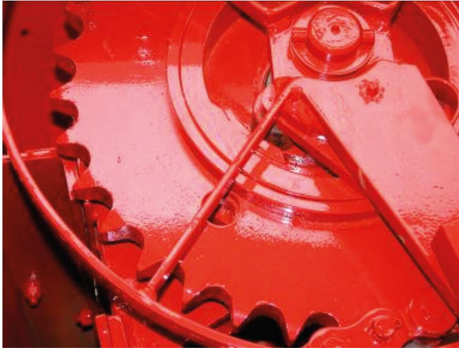
3. Actúe sobre el engrane para insertar el nuevo perno de seguridad.
