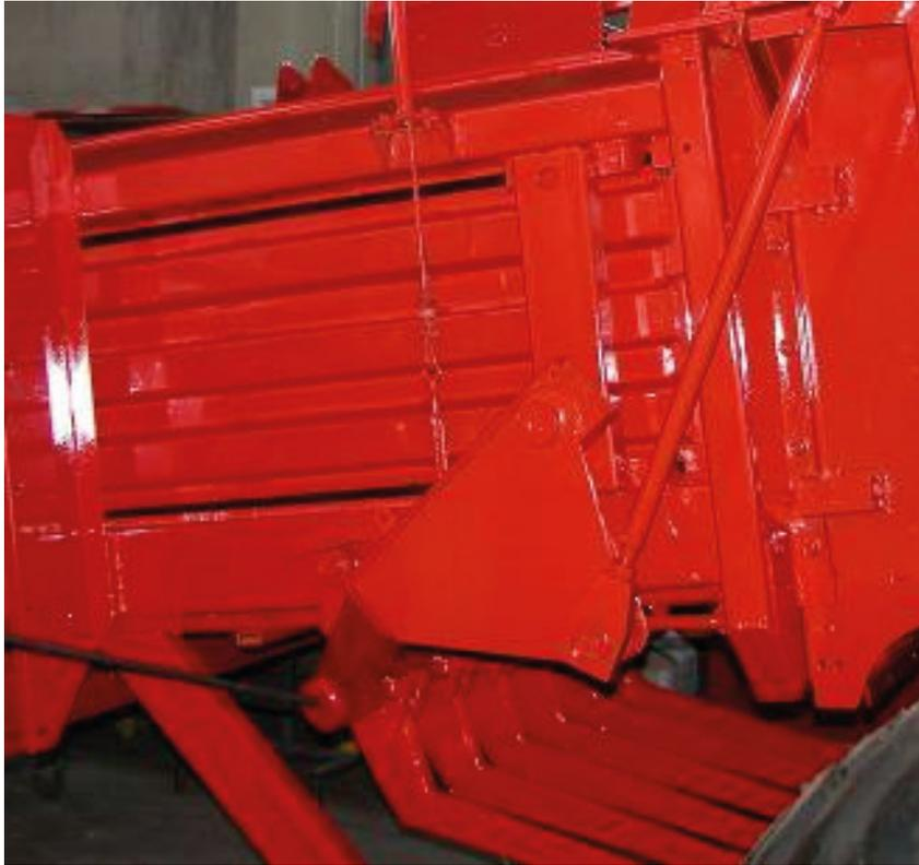
En esta posición el bloqueo del pistón debe estar 5 -10 mm de la parte superior, como abajo.
