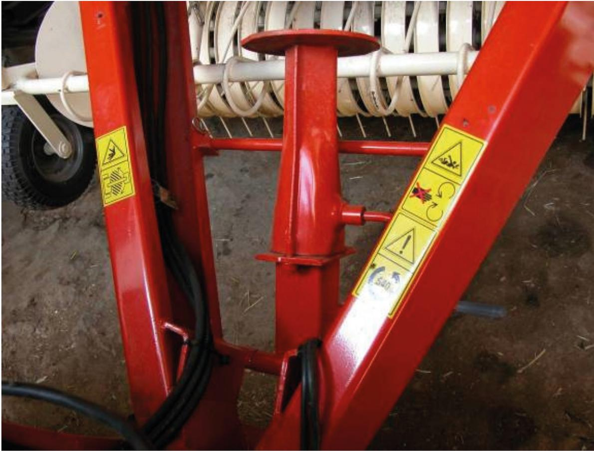
Después de conectar la máquina al tractor, conecte el eje cardán.
