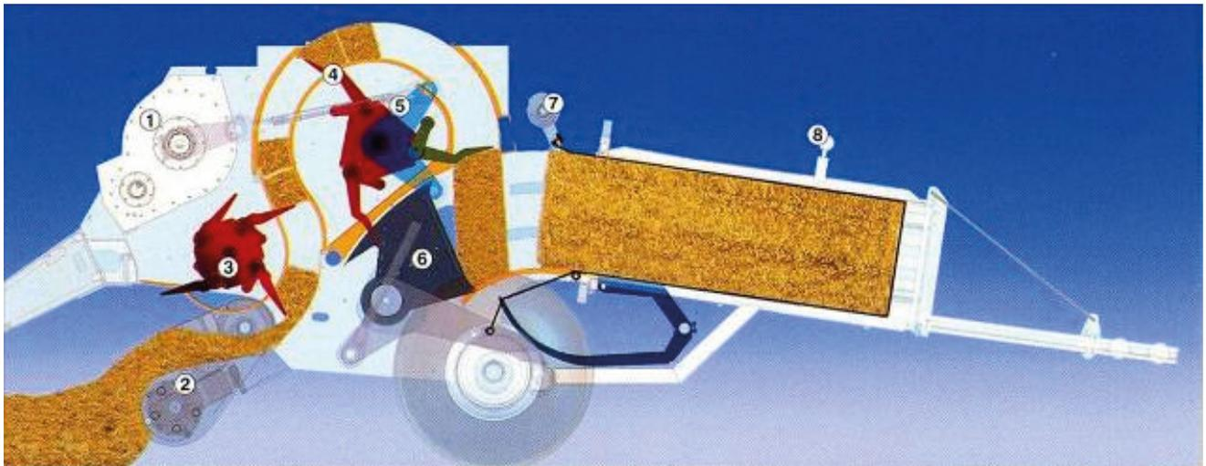
El eje cardán acciona un REDUCTOR BIFÁSICO (1) y mediante un MOVIMIENTO BALANCEADO (5) al ÉMBOLO (PISTÓN) (6).
