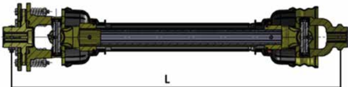
Figura 7- Eje Cardán de la Toma de Fuerza
