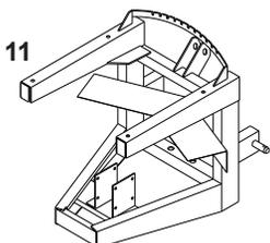
11.- Chasis: Cortado en laser y soldado con robot y recubierto con pintura epoxica.
