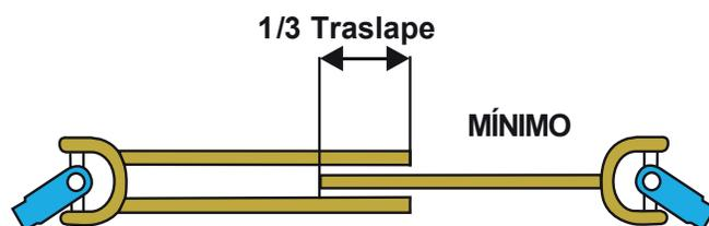
**NOTA:** Identifique que lado va al tractor y que lado al equipo (en la etiqueta que tiene la toma de fuerza). Recuerde que siempre debe ir el tubo hembra del eje cardán al lado del tractor.
