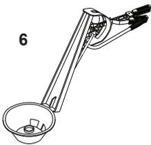
6.-Dosificador orientable: Permite compensar la dosificación para ambos lados.
