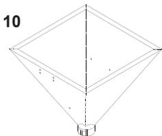
10.- Tolva Su diseño favorece el flujo del fertilizante hacia las compuertas de salida.
