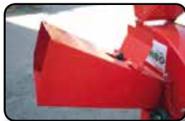
Amplias bocas de entrada con tapa reguladora
