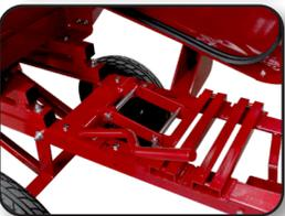
Palanca para aflojar las bandas que facilita el arranque del motor y el tensado para su funcionamiento.
