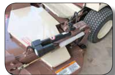
Levante hidráulico en el sistema de corte.
