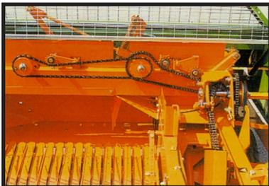
Los tensores de cadenas, aseguran un reducido desgaste y aumentan la duración de todas las cadenas de transmisión. El mantenimiento es mínimo.
