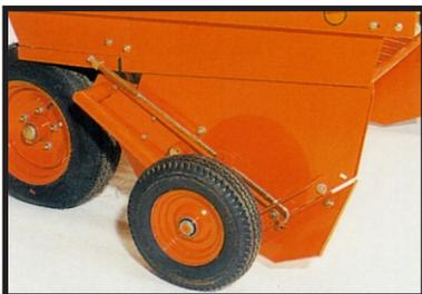
La rueda neumática del pick-up, ideal para regular la altura de recolección, es amovible y durante el transporte se coloca en la parte posterior de la máquina.
