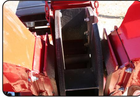
Volante de trituración fabricado en acero de alto espesor, cuenta con 1 navaja a cada lado, balanceo dinámico y palas expulsoras de material.
