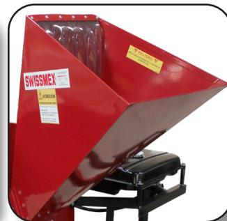
2 bocas de alimentación con cortinas de seguridad que evitan la salida de material.
