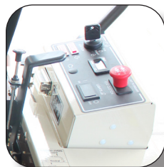
Caja de mando al alcance del operador.
