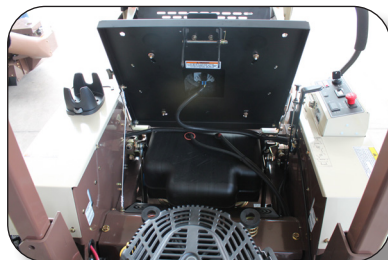
Sistema de enfriamiento ciclónico.
