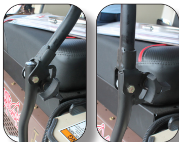
Palancas ajustables sin necesidad de herramientas.
