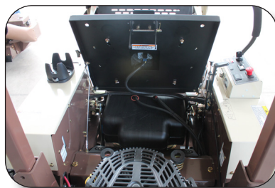
Sistema de enfriamiento ciclónico.
