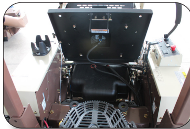
Sistema de enfriamiento ciclónico.
