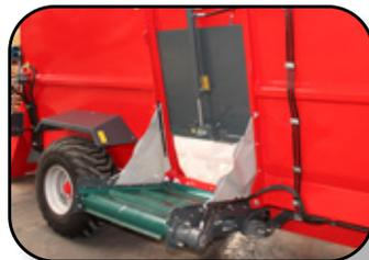
DESCARGA LATERAL POR COMPUERTA REGULABLE (OPCIONAL IZQ O DER)
