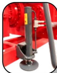
PATA SOPORTE HIDRÁULICA
