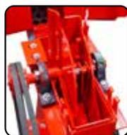
Rotor de molienda con martillos móviles y navajas volteables doble vida para moler material verde y/o seco.
