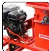
Palanca para aflojar las bandas que facilita el arranque del motor y tensarlas para su funcionamiento.
