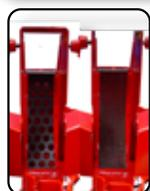
4 Cribas de 1/2", 1/4", 1/8" y 1" para diferentes tipos de molienda de sencillo método de intercambio.
