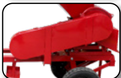
Protección de seguridad en las bandas.
