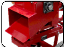
Boca de descarga hacia al piso.
