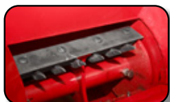
Rotor de molienda con cuchilla de acero de alta dureza para el picado.
