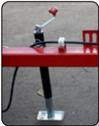
Pata para soporte, de activación mecánica
