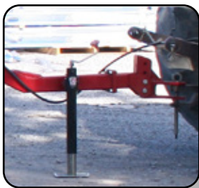
Pata soporte para descanso y facilidad de enganche
