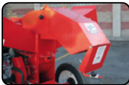
Boca de salida con contrapeso
