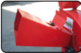
Amplias bocas de entrada con tapa reguladora
