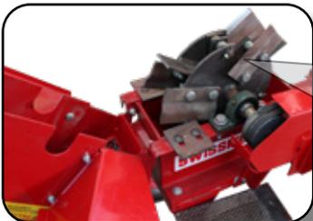
Trinquete para el acceso al rotor y el intercambio de cribas.
