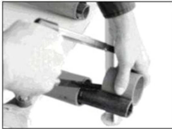
Figura 11.C- Ajuste del eje a una altura adecuada
