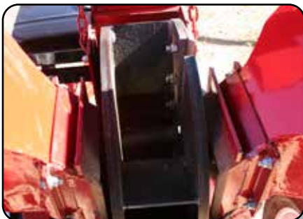
Volante de trituración fabricado en acero de alto espesor, cuenta con 3 navajas a cada lado, balanceo dinámico y palas expulsoras de material.
