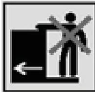
Cuando la máquina esté separada del tractor, asegúrese de que esté estacionada en un terreno compacto y nivelado: debe estar inmóvil y estable.
