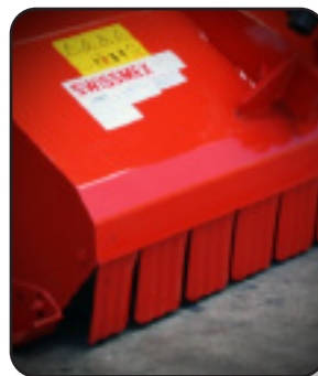
Boca de alimentación con cortinas metálicas abatibles que permiten la entrada del material a la carcasa de molienda, y evita su salida, brindando así protección y seguridad al operador.
