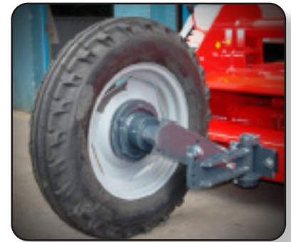
2 llantas (6.00-16) de uso agrícola abatibles, con posición fija para transporte (plegadas) y posición de movimiento libre para trabajo. Y 15 posiciones para control de altura.
