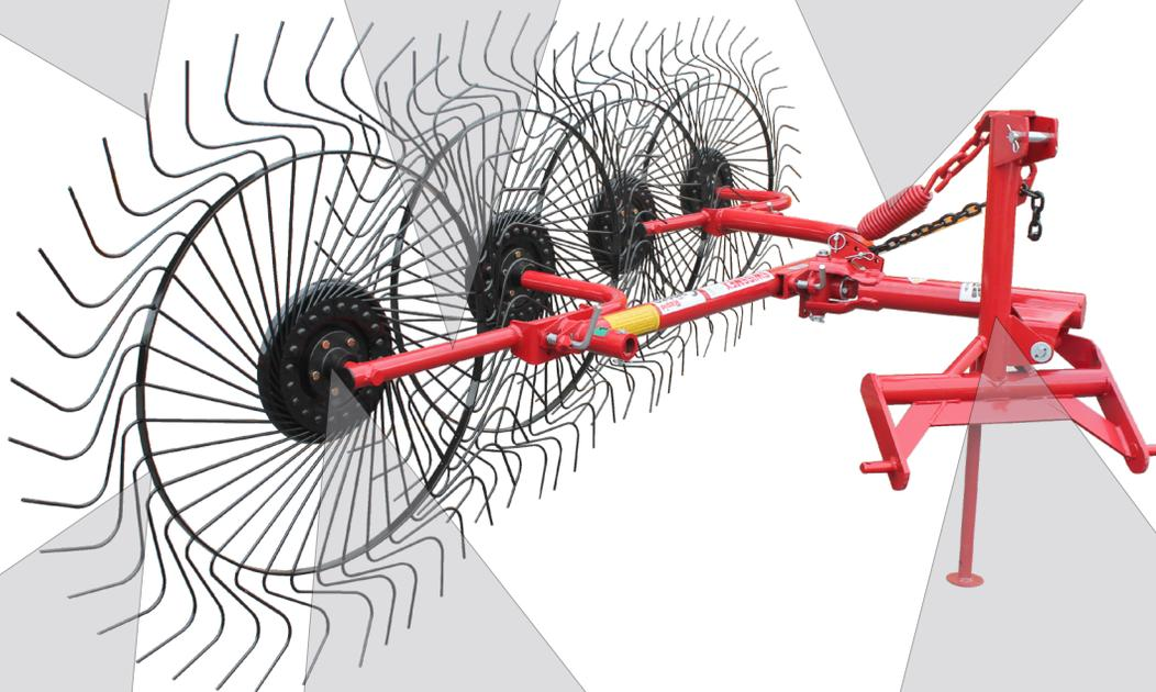
Aros de refuerzo, fabricados en solera de grueso calibre.
