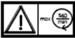
La Max. velocidad de rotación de entrada de la Rastra Desterronadora Fija es 540 RPM
