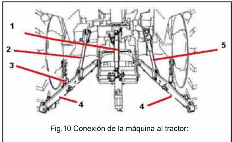
Fig.10 Conexión de la máquina al tractor:
