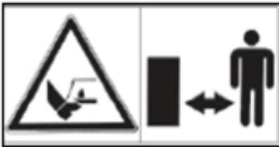
Mantengase fuera del area de las cuchillas mientras el motor del tractor esté funcionando
