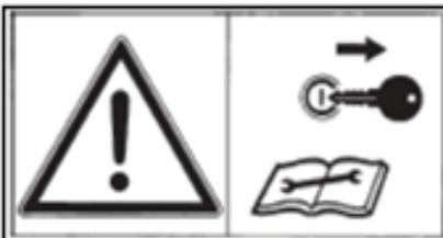
Apague el motor y quite la llave antes de realizar un trabajo de mantenimiento o reparación
