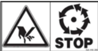
Espere hasta que todos los componentes de la máquina hayan parado completamente antes de tocarlos
