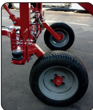
Llantas 205/75R16 (no revitalizadas) móviles que se acoplan a la distancia del surco.
