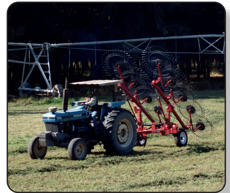
Subir y bajar los brazos es una tarea sencilla gracias a su sistema hidráulico el cual es totalmente controlable desde la cabina del tractor. Foto: Posición de transporte.
