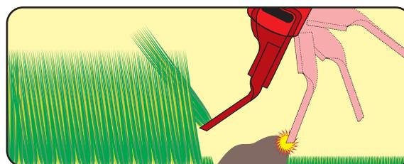
Sus navajas de flotación libre en el rotor están especialmente diseñados para evitar daño a la máquina cuando chocan con material duro como piedras.
