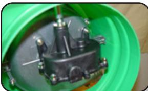
Caja de engranes, fabricada con los mejores materiales y una relación 1:27 en sus engranes, dandole mayor velocidad y volumen de aire
