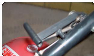
Palanca para desplazar la barra de soporte y dirección
