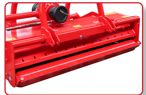
Rodillo y cortina trasera ajustable
