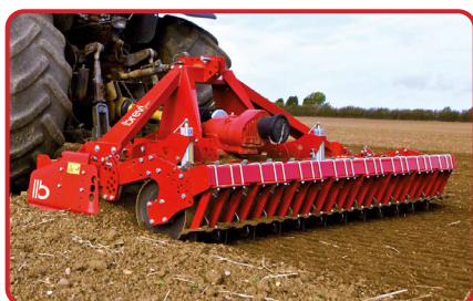
Rodillo Packer prepara la tierra para una buena infiltración
